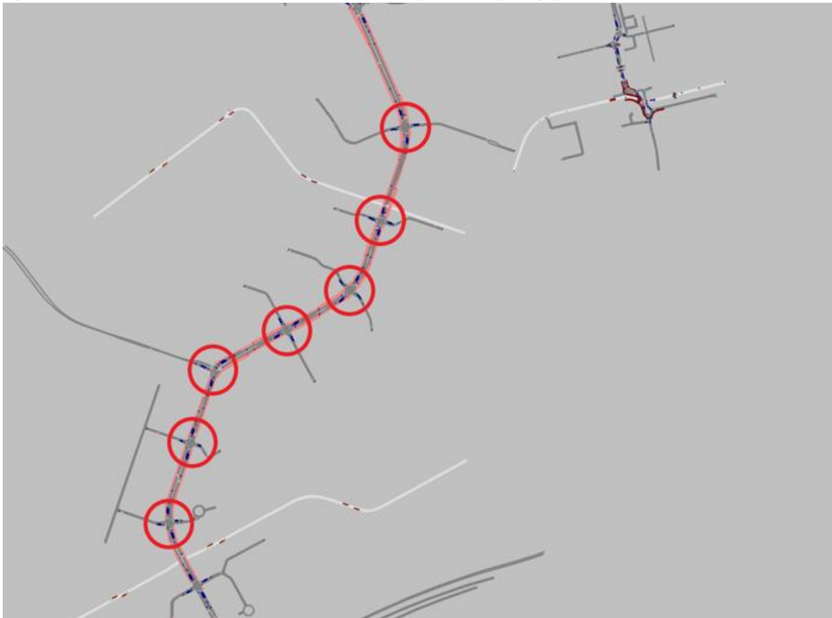
Figuur 4. Gemodelleerd verkeersnetwerk waarin TopTrac en TopTracFlex zijn toegepast.
